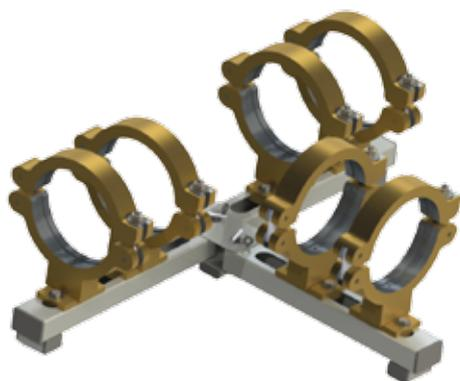
Позиционер «Ястреб» со сдвоенными зажимами предназначен для фиксации ПНД труб и/или фасонных изделий диаметром 32-160 мм в процессе электромуфтовой сварки и позволяет эффективно бороться с овальностью и продольной кривизной труб, поставляемых в бухтах.
