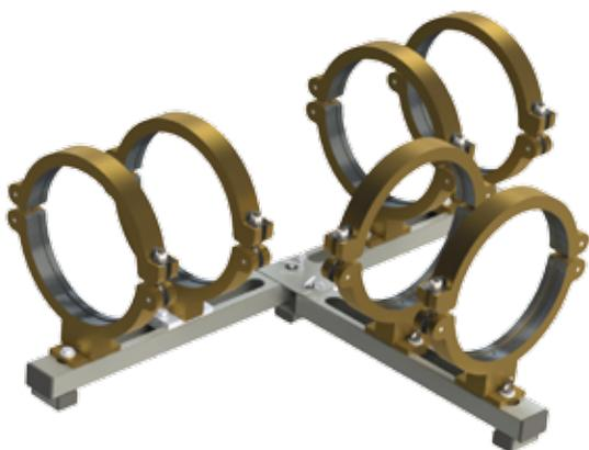
Позиционер «Ястреб» со сдвоенными зажимами предназначен для фиксации ПНД труб и/или фасонных изделий диаметром 32-250 мм в процессе электромуфтовой сварки и позволяет эффективно бороться с овальностью и продольной кривизной труб, поставляемых в бухтах.
